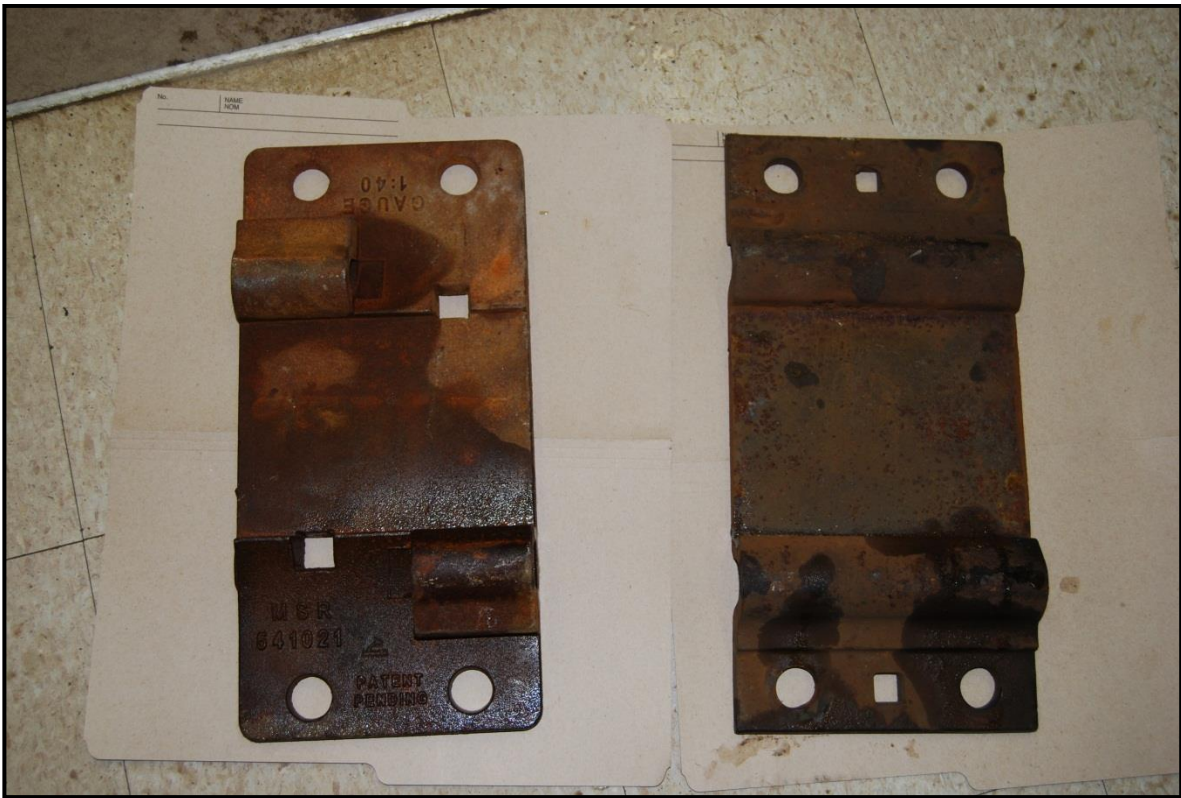
Photo 6. Selle moulée (à gauche) et selle laminée (à droite)
