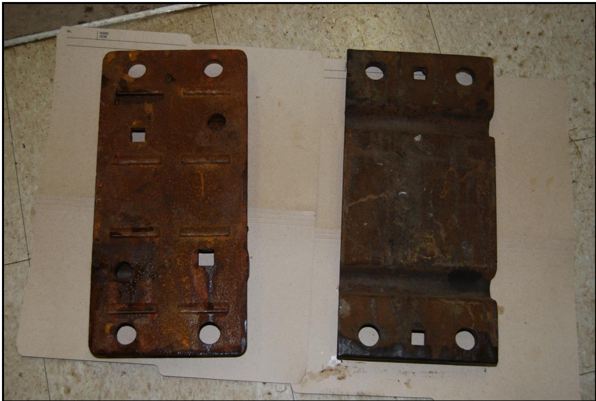
Photo 7. Dessous des selles (à noter : saillies sur le dessous de la selle moulée, à gauche; dessous lisse de la selle laminée, à droite)
