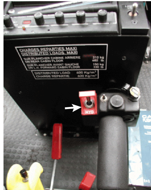
Photo 2. Commutateur CUTOFF du circuit hydraulique et son cache
