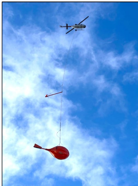
Figure 1. Un hélicoptère Bell 206L équipé d'une longue élingue de 300 pieds et d'un capteur de levés géophysiques (oiseau) (Source : Hanley Heli Service Inc.)
