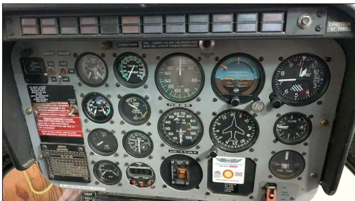
Figure 4. Le tableau de bord de l'hélicoptère de l'événement à l'étude, agencé selon la disposition standard en « T » (Source : tierce partie, avec autorisation)
