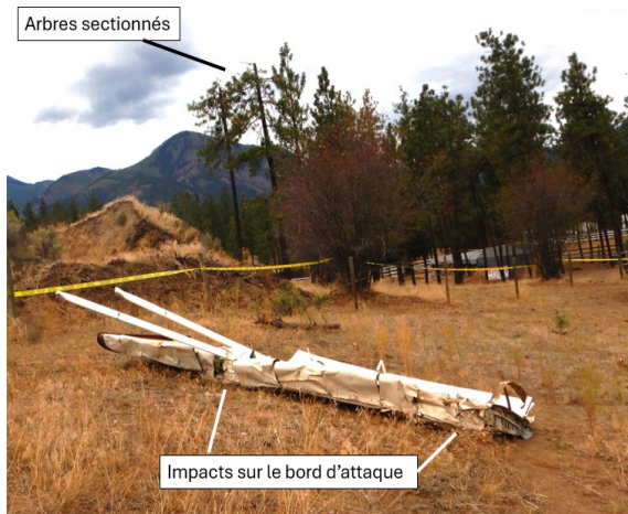
Figure 3. Aile gauche avec les zones d'impact sur le bord d'attaque et arbres sectionnés (Source : BST)
