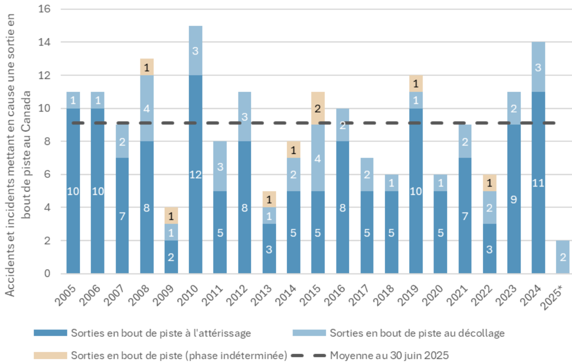
Figure 1. Accidents et incidents mettant en cause une sortie en bout de piste au Canada, de janvier 2005 à juin 2025 (Source : BST)
