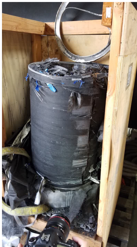
Figure 10. Modèle à l'échelle après l'implosion (Source : Patrick Loomis)
