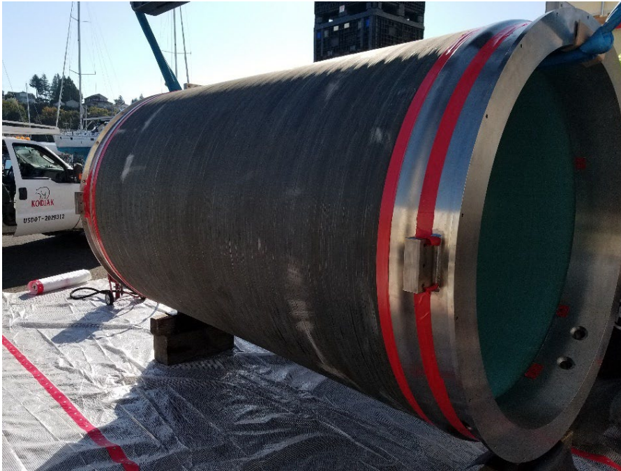
Figure 13. Cylindre à pleine échelle avec anneaux en titane de la première construction du Titan (Source : Patrick Loomis)
