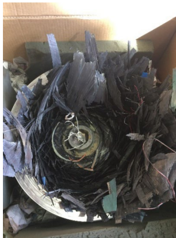
Figure 12. Dôme d'extrémité en fibres de carbone après l'essai (Source : Patrick Loomis)
