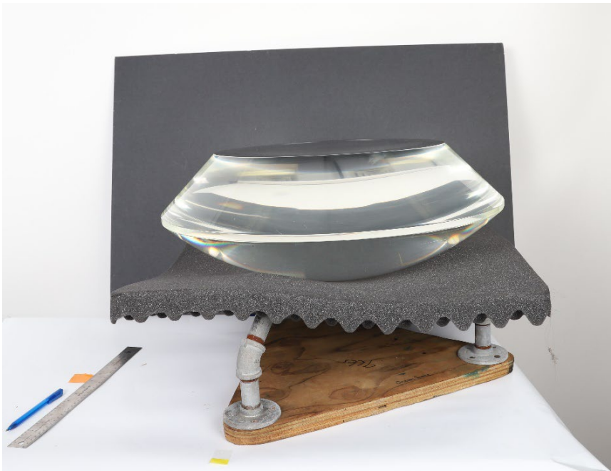
Figure 14. Conception du hublot achevé conçu pour une pression nominale de 6,516 mPa (Source : BST)
