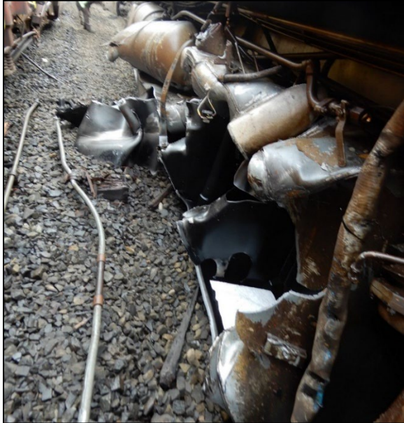
Figure 4. Réservoir de carburant gravement endommagé de la locomotive de tête du train 804
