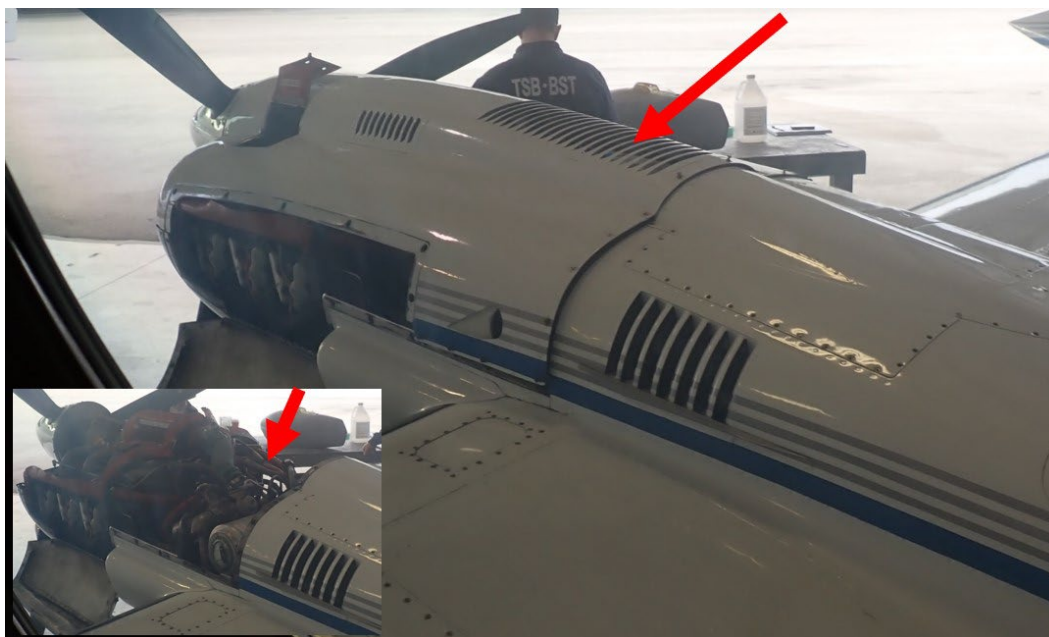
Figure 3. Emplacement approximatif de l'incendie en vol indiqué par des flèches, avec une image en médaillon montrant l'emplacement approximatif de l'incendie une fois le capot supérieur du moteur retiré. L'aéronef représenté est un Cessna 421B, qui possède le même moteur et la même nacelle que le Cessna 421C (Source de l'image principale et de l'image en médaillon : BST)
