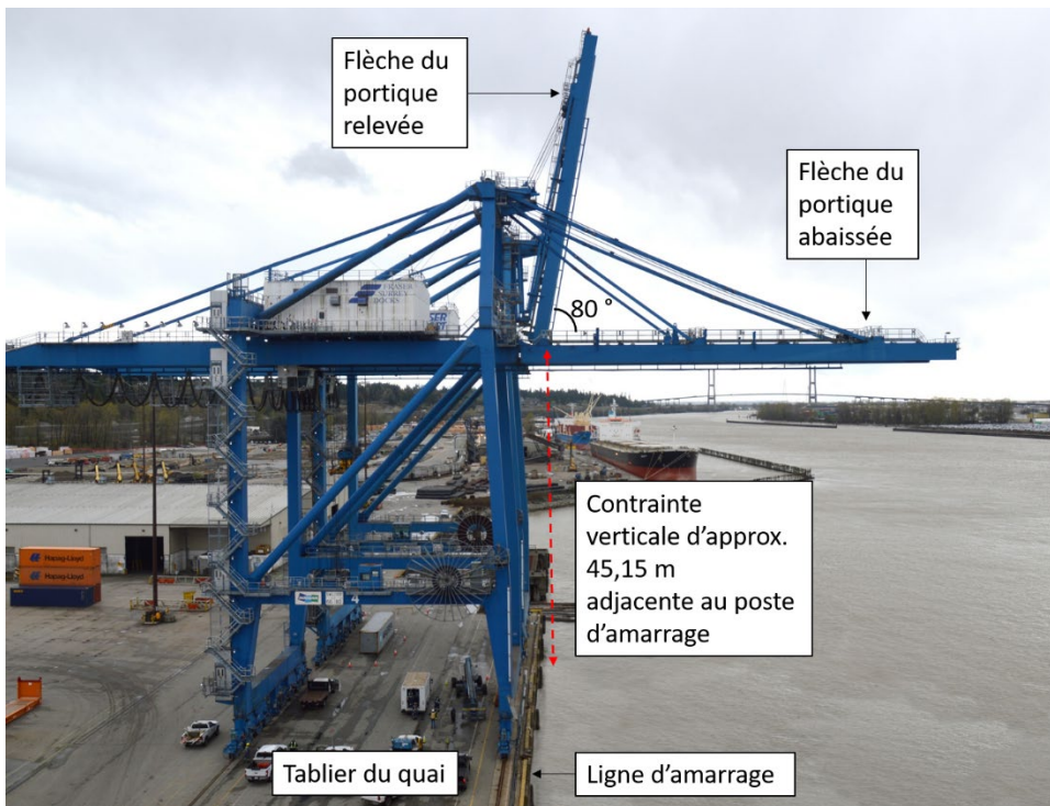
Figure 6. Contrainte verticale du portique au poste d'amarrage (Source : BST)
