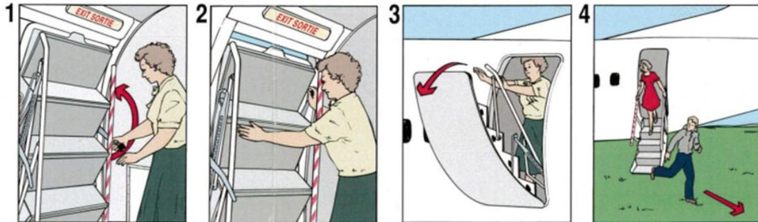
La porte de service (D2) se trouve en face de la porte d'accès arrière, du côté droit de l'aéronef. Cette porte s'ouvre manuellement vers l'extérieur et peut servir d'issue de secours, si nécessaire.
