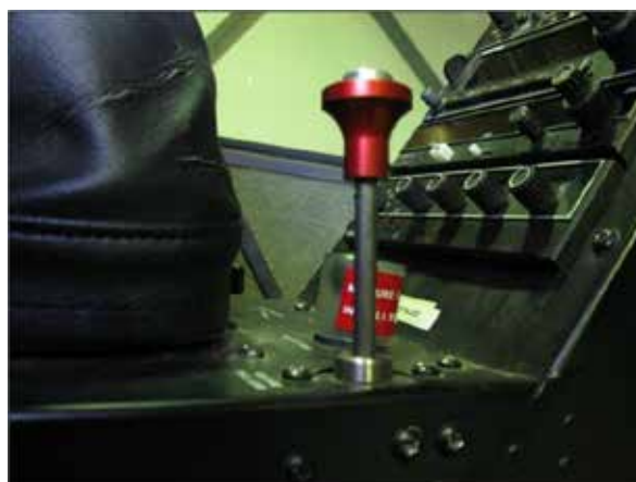
Photo 3. Commande de mélange air/carburant en position étouffoir
