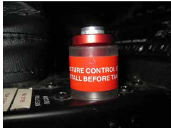
Photo 2. Commande de mélange air/carburant avec protecteur en place
