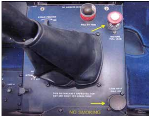
Photo 1. Commande de mélange air/carburant en haut à droite et commande du réchauffeur du carburateur en bas à droite
