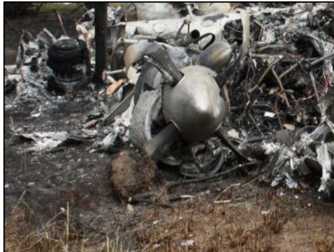
Photo 1. Dommages à l'hélice du moteur gauche
