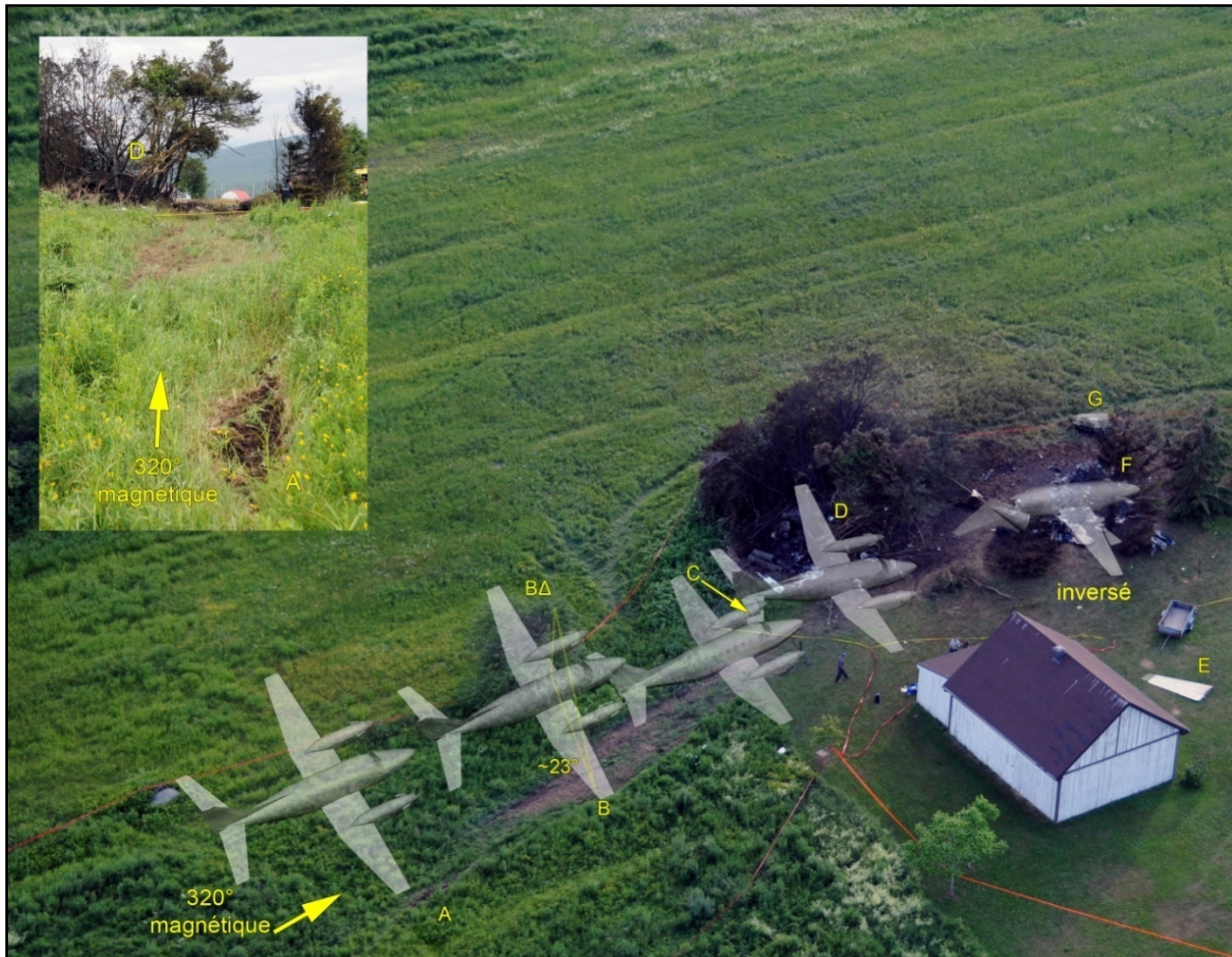
Figure 4. Illustration de la séquence d'impact
