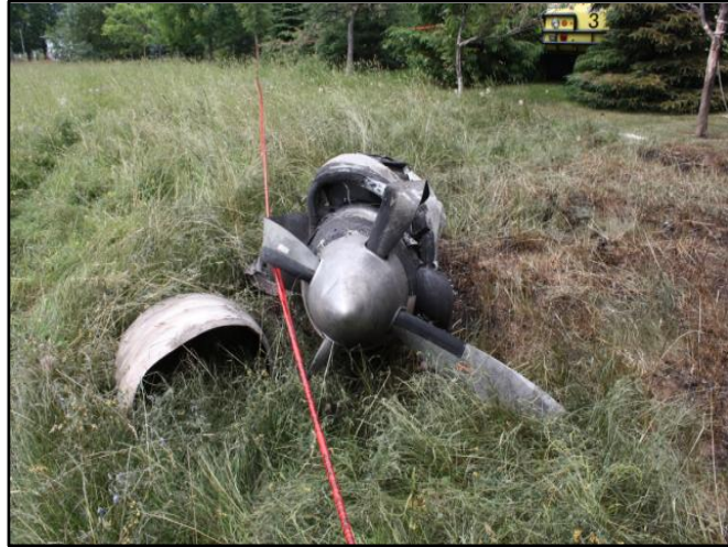
Photo 2. Dommages à l'hélice du moteur droit
