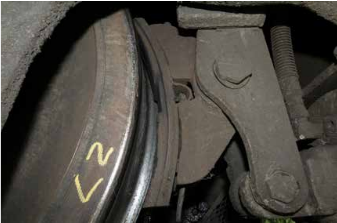
Figure 7: Semelle de frein installée montrant une usure asymétrique
