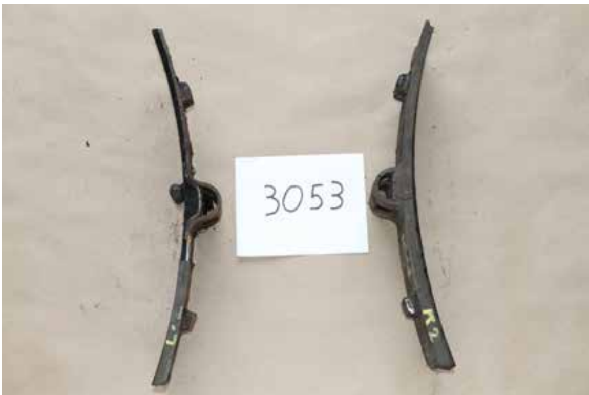
Figure 8: Exemple de semelles de frein dont la garniture a presque disparu
