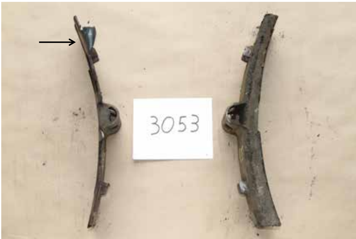
Figure 9: Exemple d'une semelle de frein dont la garniture est usée jusqu'à la plaque de fixation (flèche)
