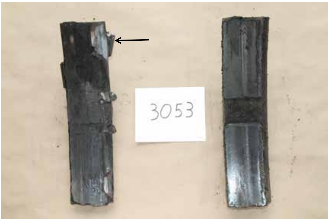
Figure 10: Vue, du côté de la table de roulement, d'une garniture de semelle de frein usée jusqu'à la plaque de fixation (flèche)
