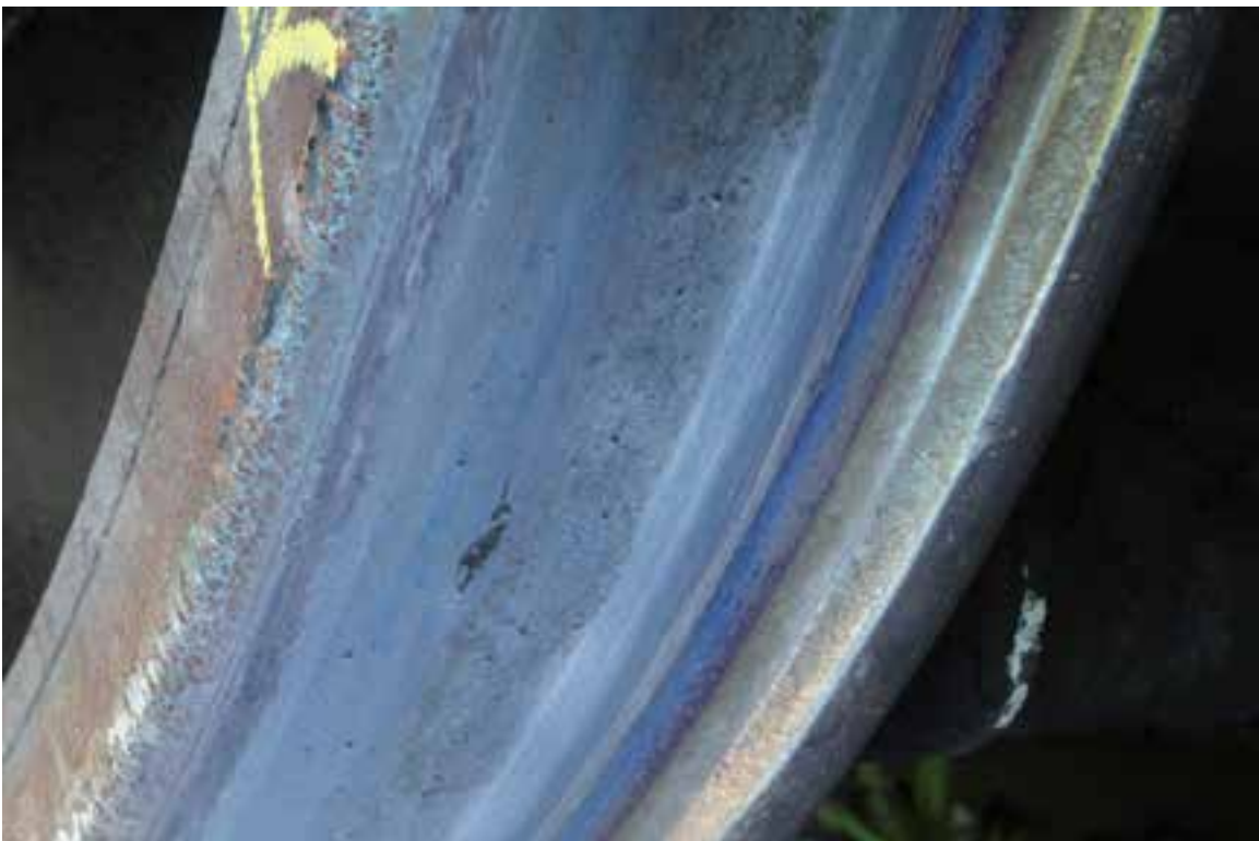
Figure 4: Exemple représentatif d'une table de roulement avec bleuissement intégral, y compris le boudin
