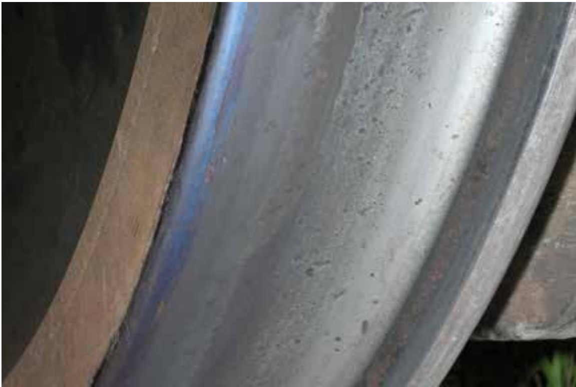
Figure 1: Exemple représentatif d'une table de roulement avec bleuissement sur \frac{1}{4} de la surface
