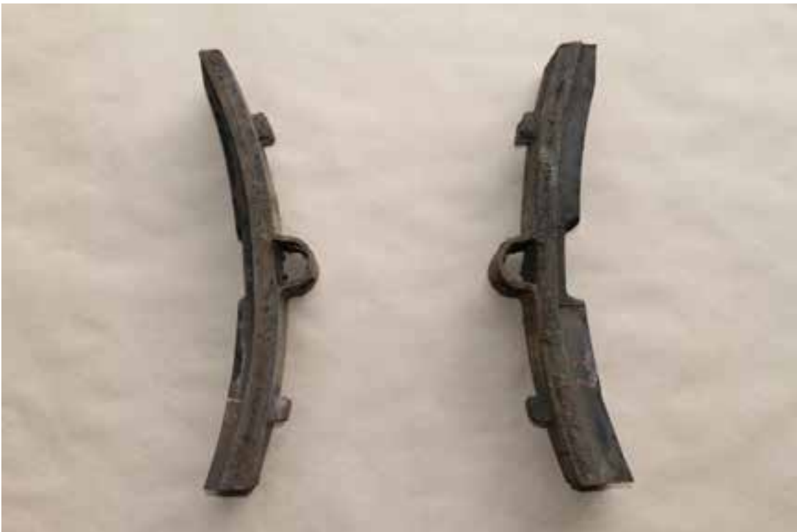
Figure 6: Semelles de frein représentatives montrant une usure asymétrique
