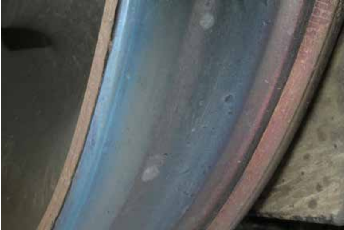
Figure 3: Exemple représentatif d'une table de roulement avec bleuissement sur \frac{3}{4} de la surface
