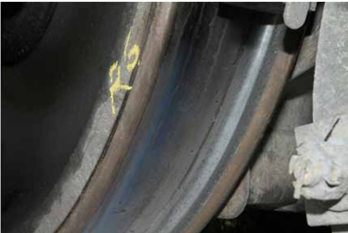
Figure 2: Exemple représentatif d'une table de roulement avec bleuissement sur \frac{1}{2} de la surface
