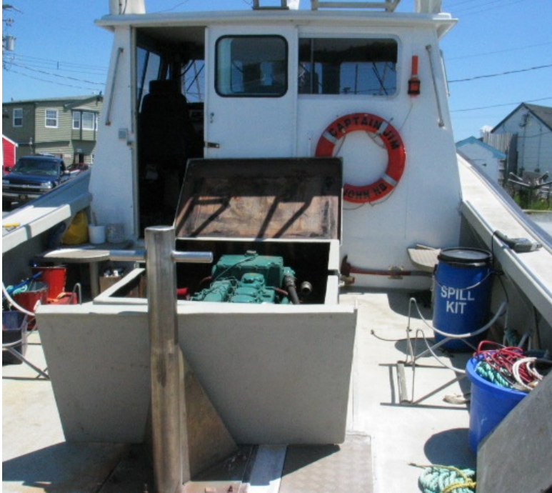
Figure 2. Vue arrière de la timonerie montrant la hiloire surélevée autour du compartiment moteur et l'un des couvercles des écoutilles (Source : tierce partie, avec permission)
