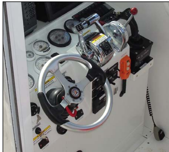
Photo 6. Coupe-circuit et position des manettes de puissance (à noter le cordon de sécurité enroulé sur le volant)
