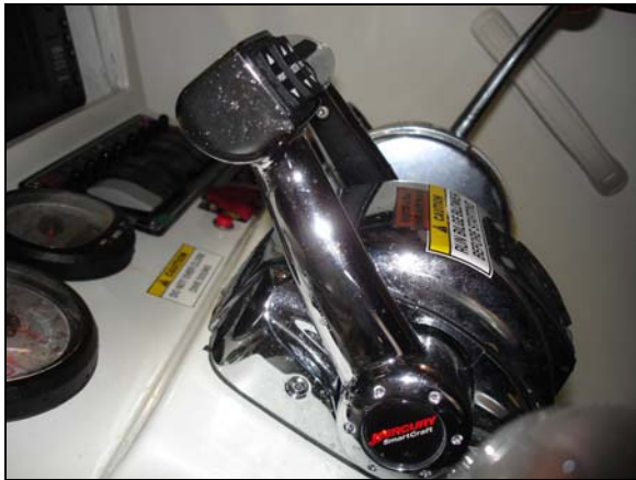
Photo 7. Position des manettes de puissance (après le chavirement) en position trois-quarts avant
