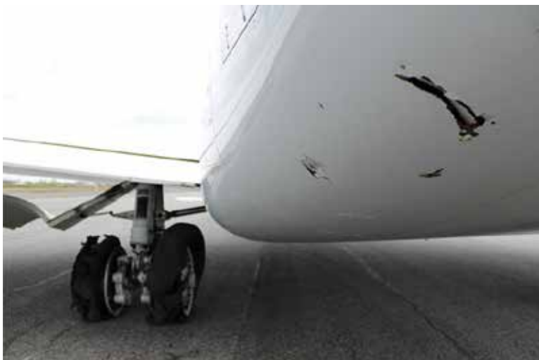
Figure 2. Vue des dommages au train d'atterrissage principal gauche et au fuselage central arrière
